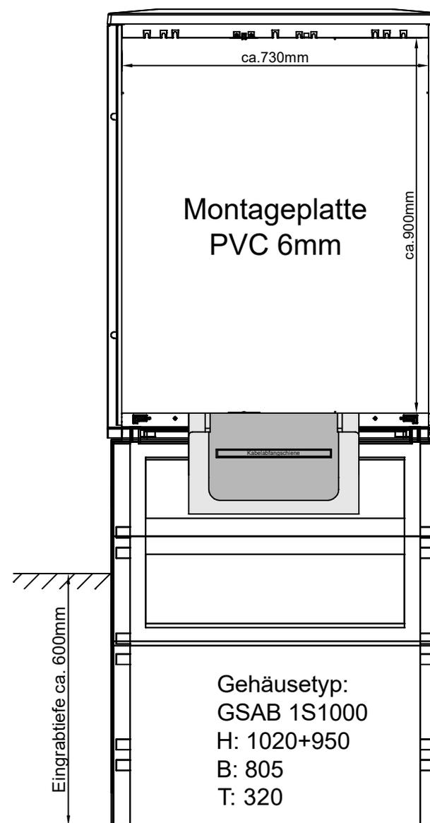
Sockel 1FS (mit eingebauter FP-Einführung) ist sep. zu bestellen
