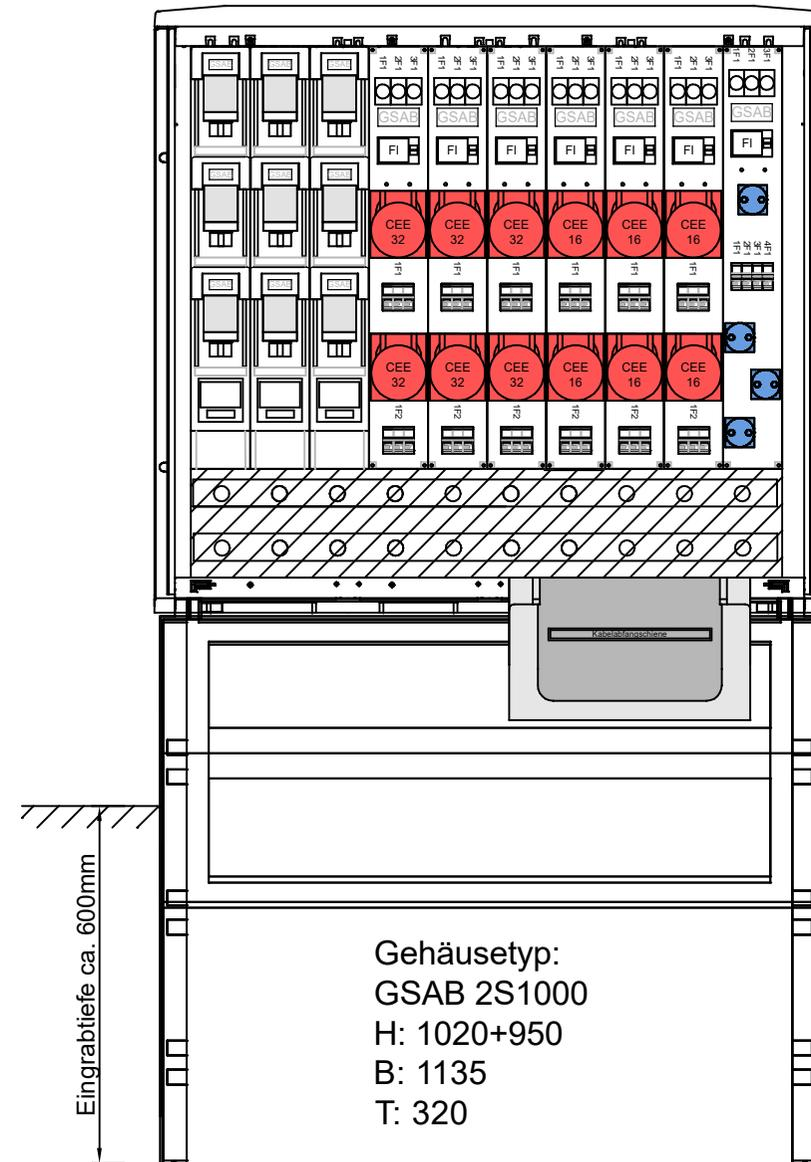
Sockel 2FS (mit eingebauter FP-Einführung) ist sep. zu bestellen
