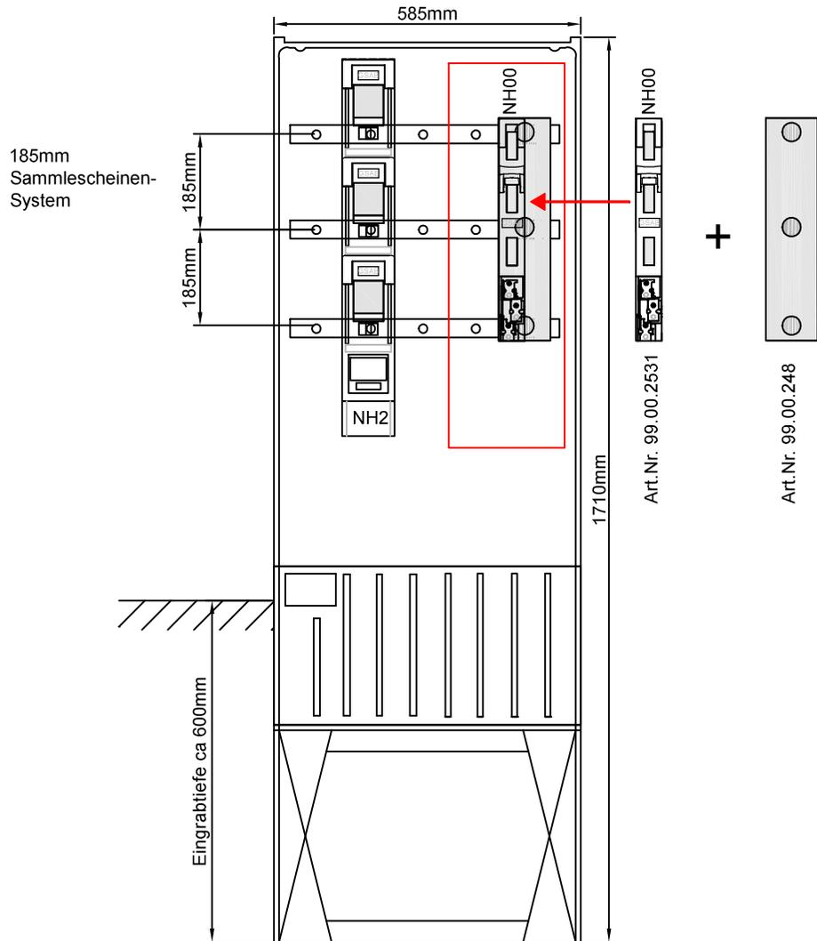
Ausführungsbeispiel NH00 Sicherungslastschaltleisten auf 100mm Sammelschienen-System ohne Adapter (Keine Kombination mit NH2 Leisten möglich!)
